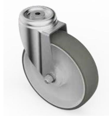
Räder aus Polyamid-6 und Lauffläche aus gespritztes Polyurethan, Härte 82 Shore A, die für Bodenschutz und Geräuschfreiheit sorgt
